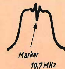
Fig. 7 - Marcatura della curva di selettività con l'aiuto di un generatore R.F.
